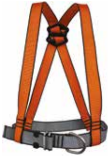
BM-45 BOSUN'S HARNESS Material : Polyester 45 mm Size : S/M, L/XL Weight Approx : 547 gr Webbing : Polyester 45 mm D-Rings : Ø 9 mm 304 Stainless Steel (EN 362) Buckle Ø 6 mm 304 Stainless Steel (EN 362)
